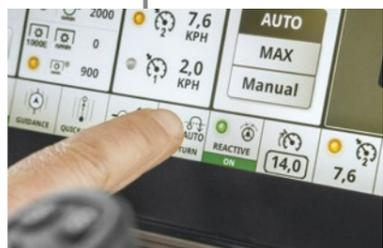
Attivate o disattivate comodamente lo sterzo reattivo tramite il CommandCenter™ in base alle vostre preferenze di guida o applicazione.
