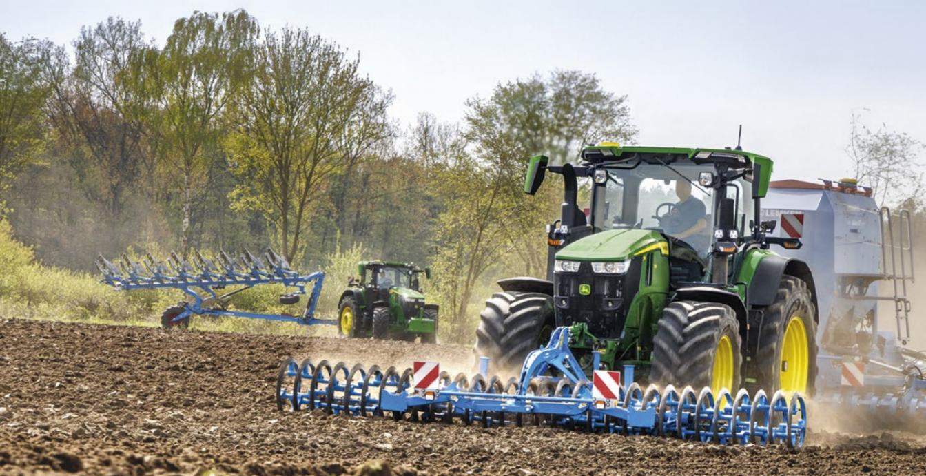
Disponibile come opzione, il sollevatore anteriore compatibile con iTEC™ ha una capacità di sollevamento massima di 3.500 kg ai ganci.
